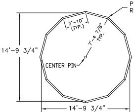
PANEL JOINTS WILL FALL ON THE RADIUS, NOT THE MIDDLE OF THE PANEL
